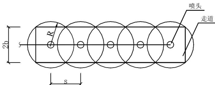
**图8 仅在走廊布置喷头的示意图**
