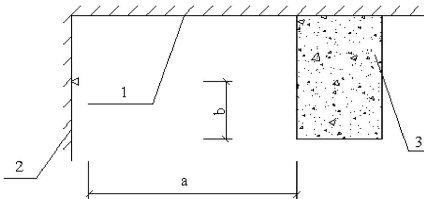
图 7.2.6 边墙型喷头与正前方障碍物的距离
