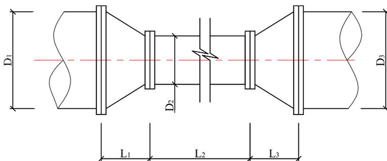
图23 节流管结构示意图
