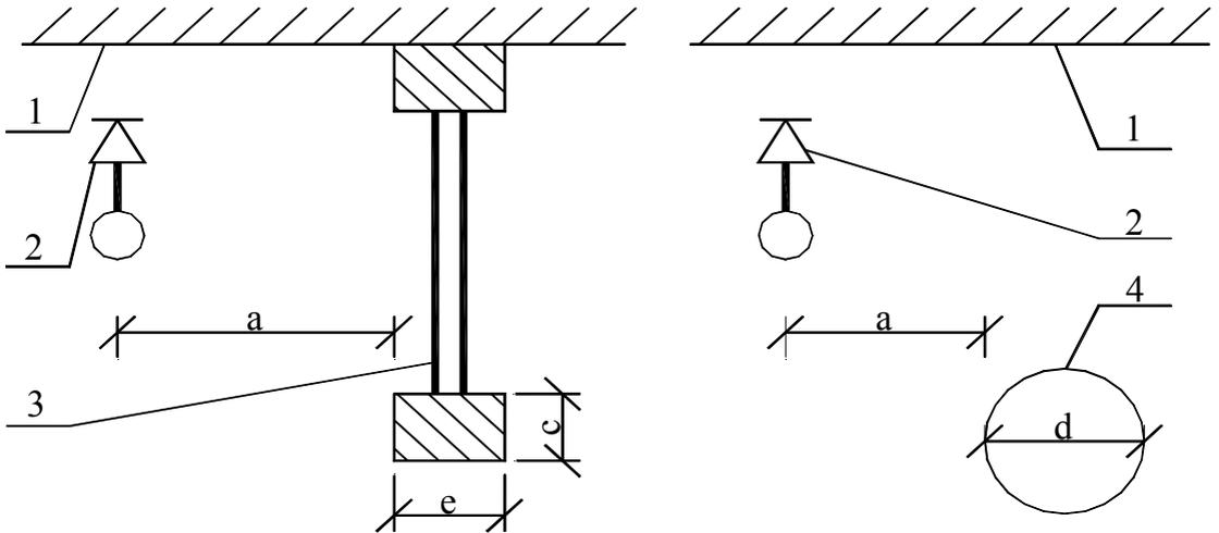
图 7.2.2 喷头与邻近障碍物的最小水平距离
