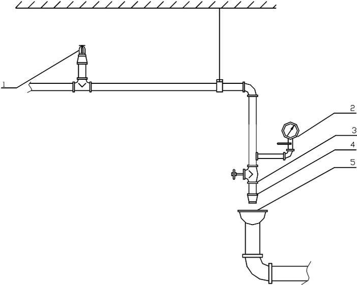
1—最不利点处喷头；2—压力表；3—球阀；4—试水接头；5—排水漏斗
