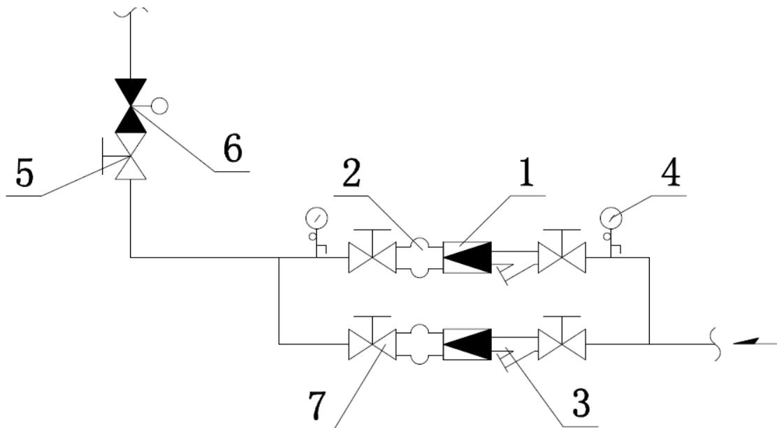
图24 减压阀安装示意图
