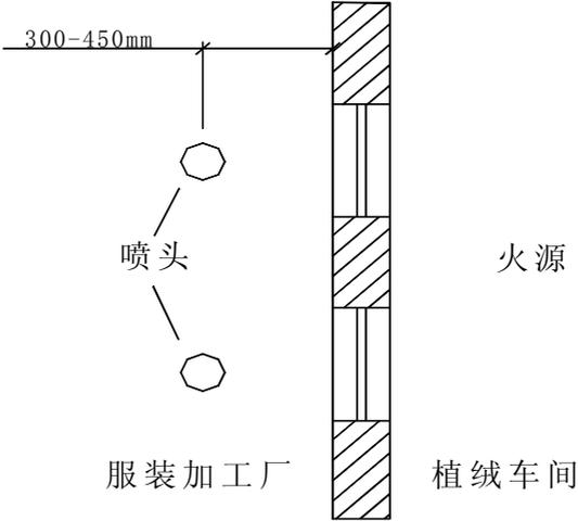
**图 15 植绒车间开口外侧设置喷头示意图**
