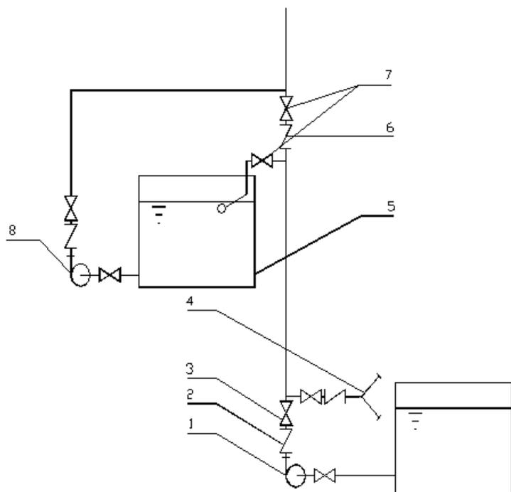
图 26 接力供水设施示意图
