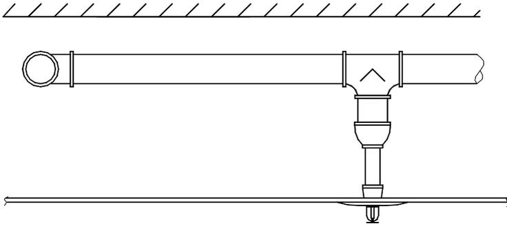
图 12 吊顶下喷头安装示意图
