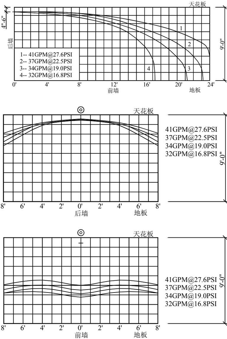
图 18 边墙型扩大覆盖面积喷头布水及喷湿墙面示意图
