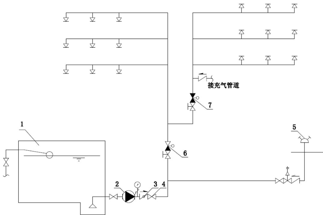
图6 其它系统接入湿式系统示意图
