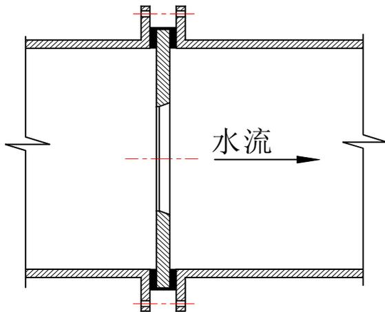
图 22 减压孔板结构示意图
