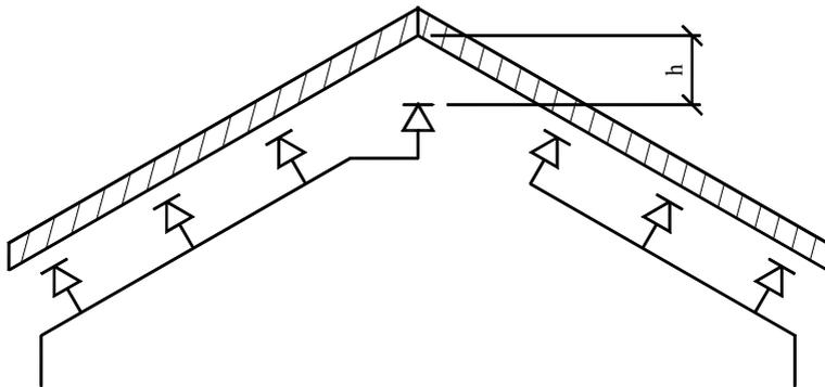
图 17 屋脊处设置喷头示意图
