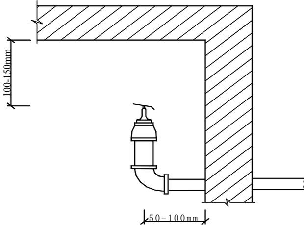
图 19 直立式边墙型喷头的安装示意图
