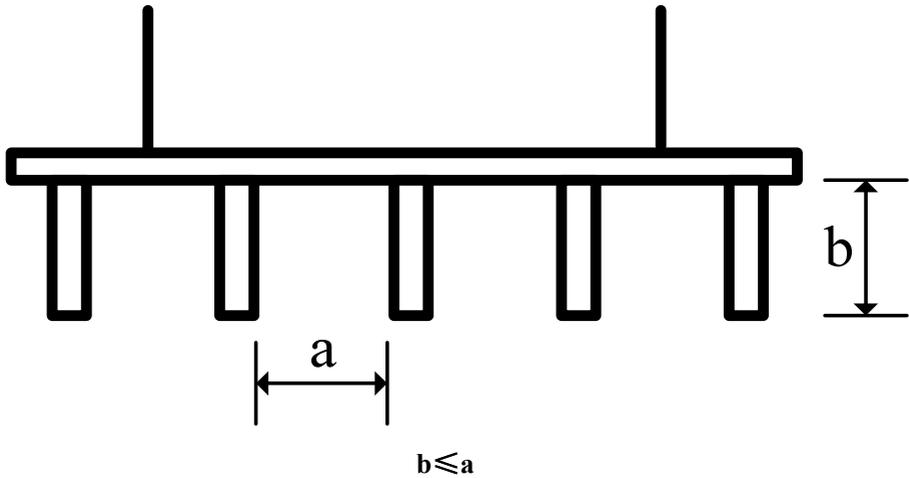
图 16 通透性吊顶的设置要求
