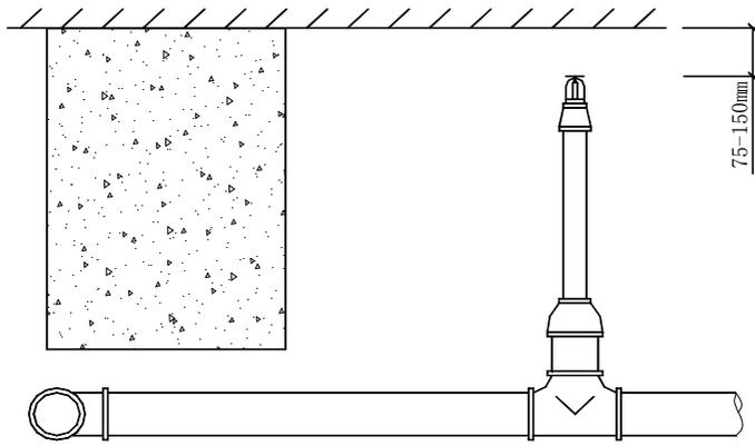
图 11 直立或下垂型标准覆盖面积喷头和扩大覆盖面积喷头溅水盘与顶板的距离
