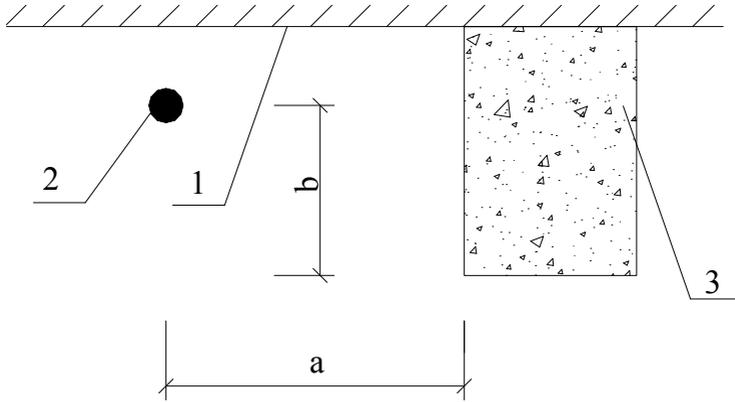
图 7.2.7 边墙型喷头与沿墙障碍物的距离
