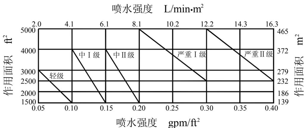
图 7 NFPA-13 中规定的自动喷水灭火系统设计参数
