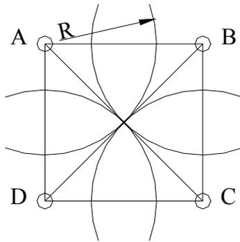
图 10 正方形布置喷头示意图
